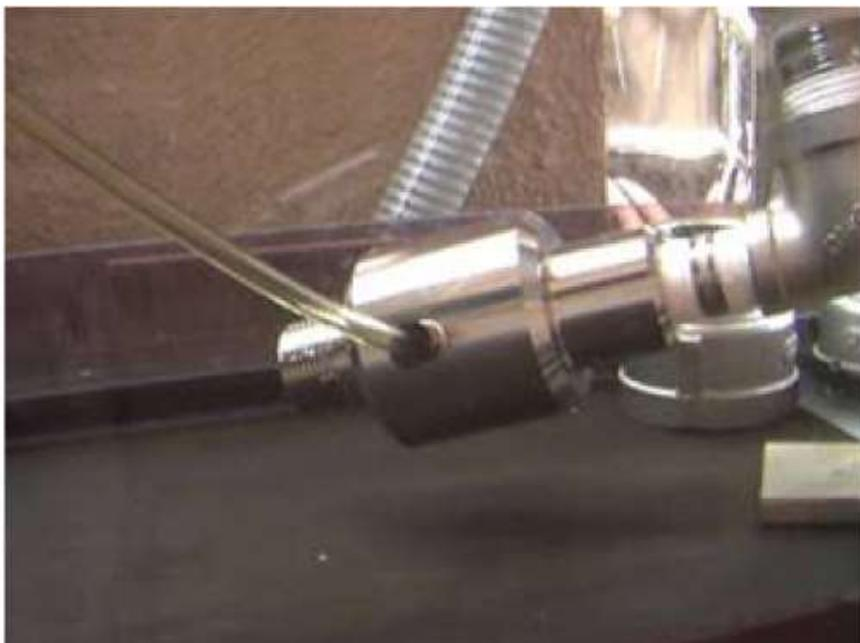
図 3: シリコンウエハーの鏡磨加工に使用の FB 発生装置 60LOK ノズル
