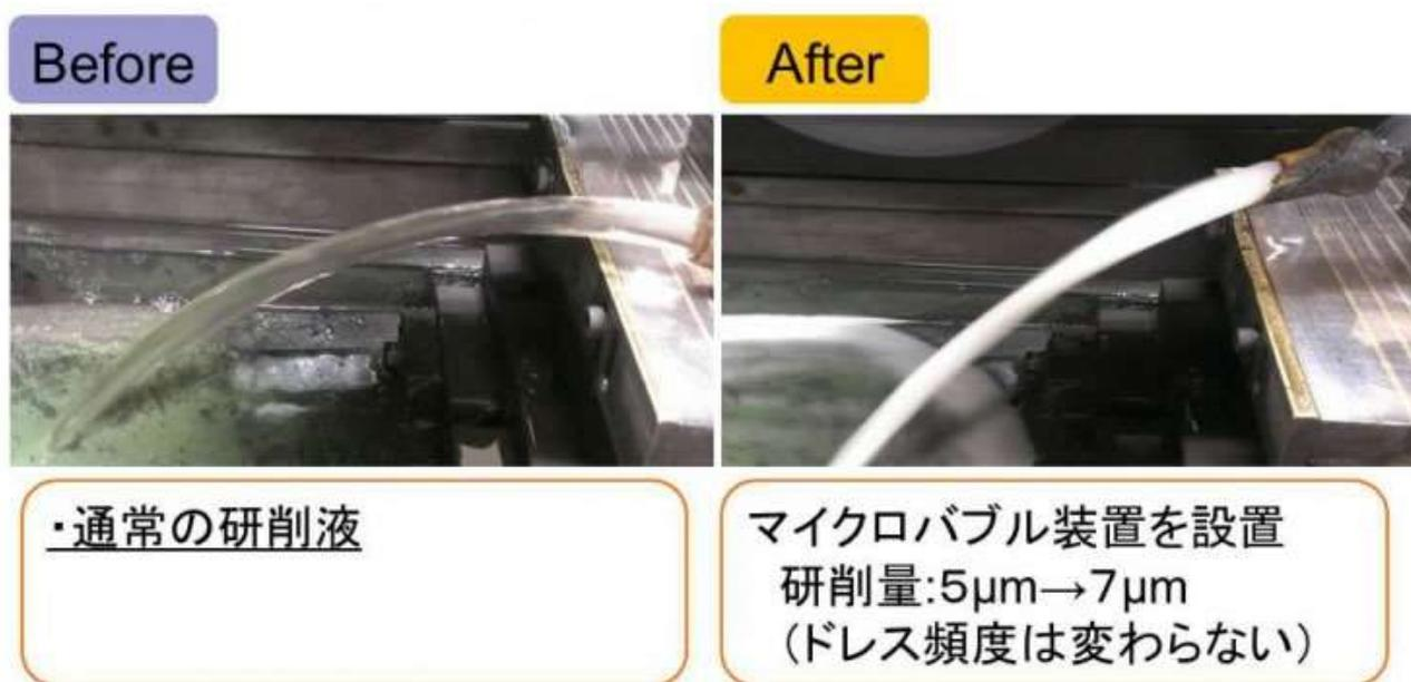
図 小型金型用研磨盤クーラント油が透明から乳白色に変化
