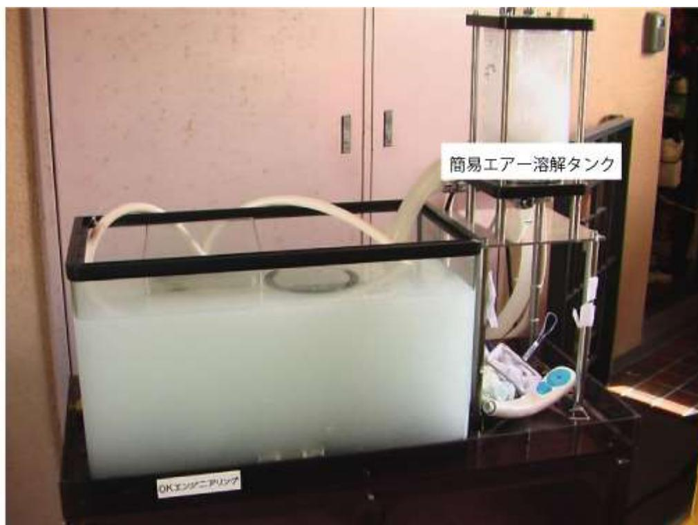
図 2: ファインバブルにより白濁した水槽
